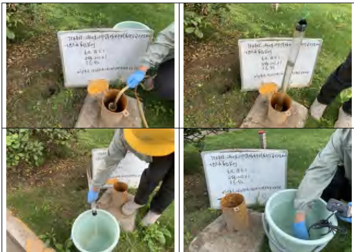
图7.2-3 采样前洗井现场照片
