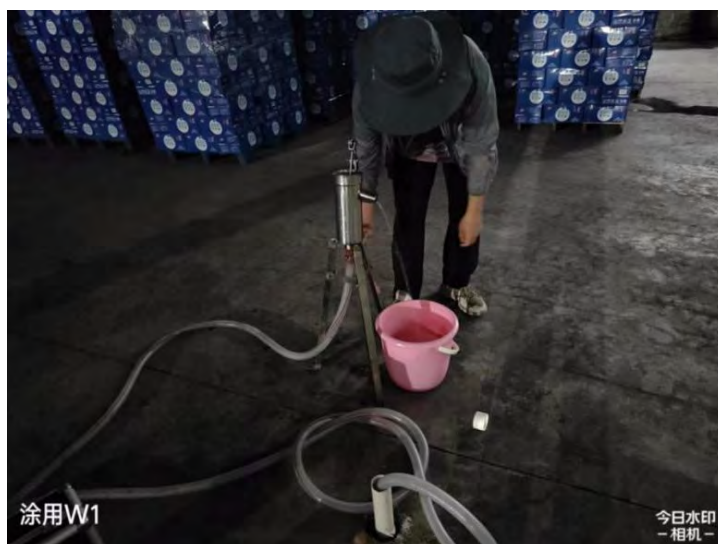
图5.2-8 采样前洗井照片
