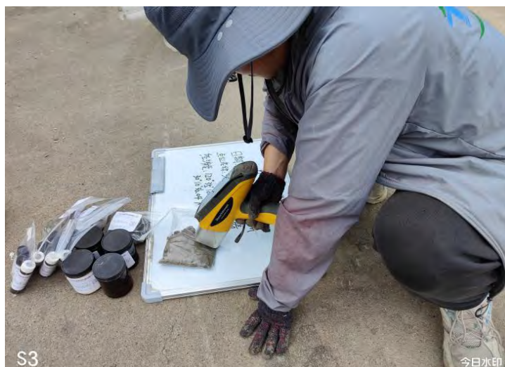
图5.1-1 土壤样品快筛照片
