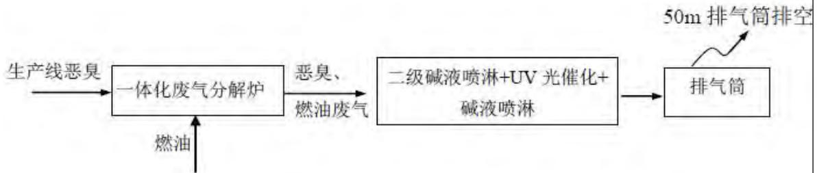
图 3-2 生产线恶臭及一体化废气分解炉燃油废气处理工艺流程图
