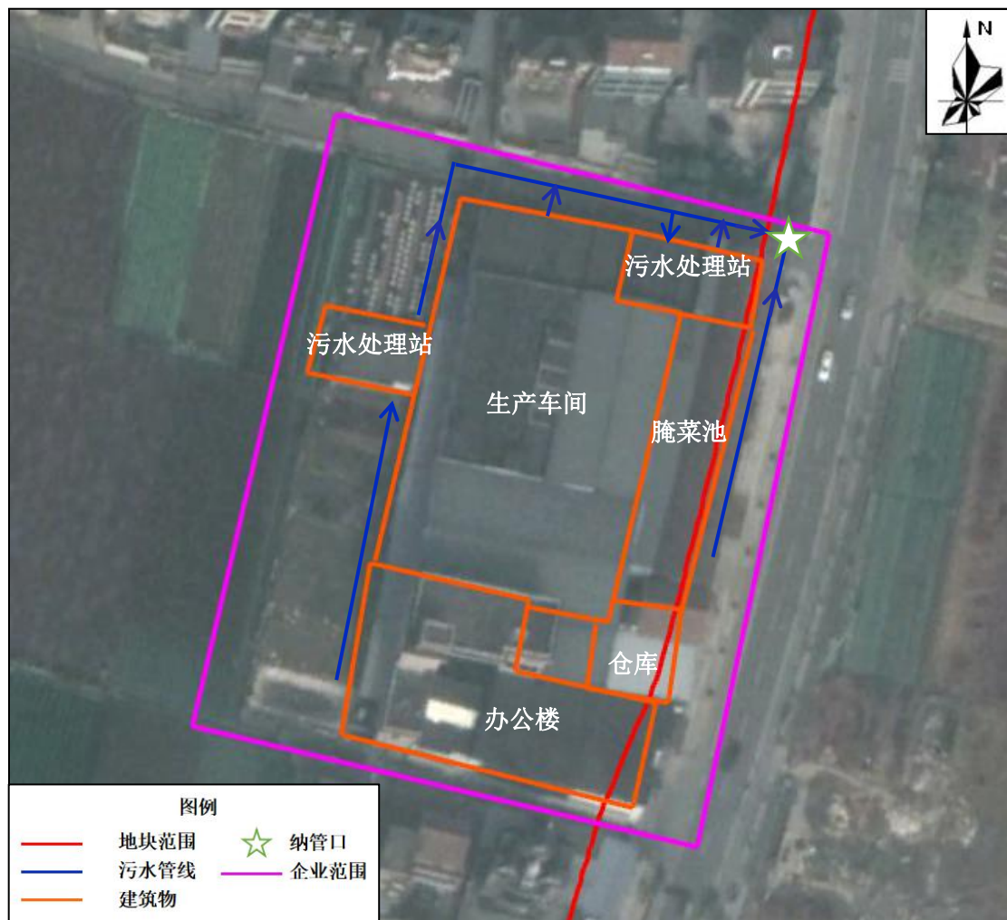
图3.6-5 杭州大地蔬菜制品有限公司平面布置及污水管网图
