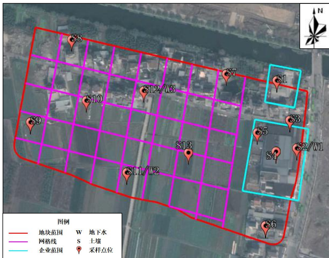
图 4.2-1 本次地块调查土壤及地下水采样点位布设图（2019 年地块内历史影像图）
