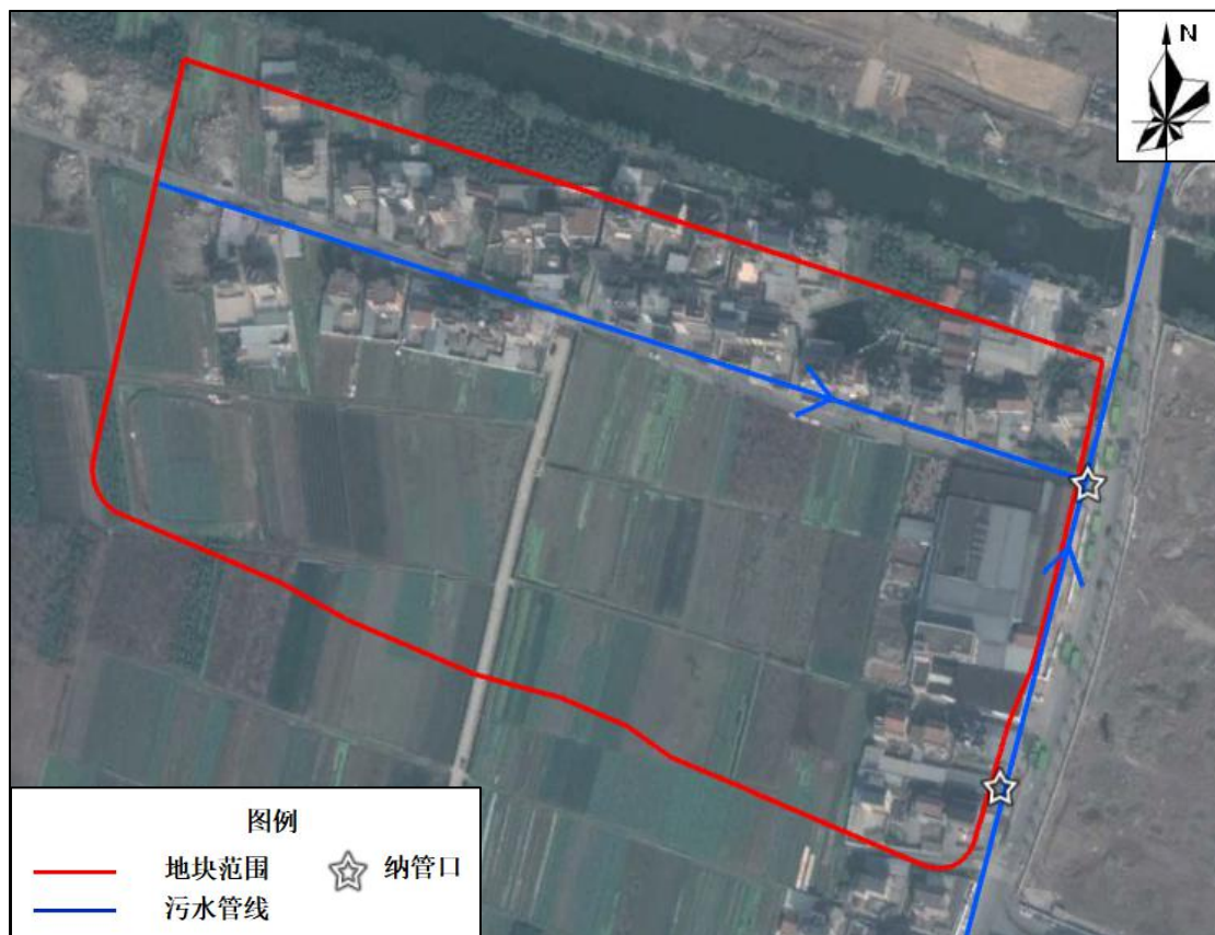
图3.6-3 污水管线图及纳管位置分布图
